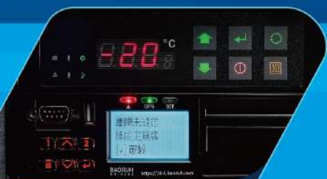
冷凍機操作介面
