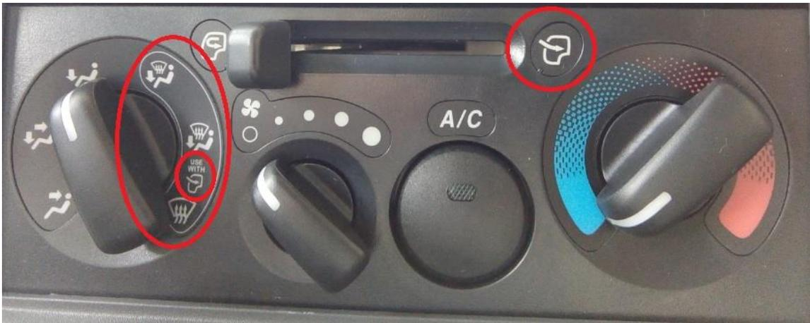
一般來說為了節省能源消耗，開冷氣時都會使用【內循環】，將車內的空氣不斷經過冷器系統來降低溫度。但既然【內循環】能夠節能且快速的降低冷氣溫度為什麼需要【外循環】的選項呢？
