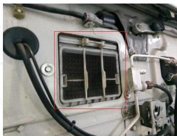
空氣濾網的功能是過濾進到冷氣系統的外部空氣，ISUZU F 系列卡車將濾網設計在引擎蓋下，可以容易的檢查濾網的狀態，維持車內空氣品質。
