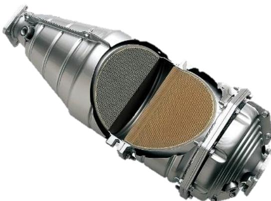
五期柴油卡車大部分都裝有碳微粒過濾器(DPD, Diesel Particulate Diffuser)環保系統，目的是在捕捉卡車於加速或引擎低溫時所排放的碳微粒也就是大家所稱的黑煙。正常情況下行車的電腦會自動偵測濾清器內的碳微粒數量，並於引擎高溫時用排氣的餘熱將其燃燒殆盡。DPD過濾器主要由具有耐高溫且極細微的濾網組成，一般來說有裝設DPD系統的碳微粒過濾效果可達70%~90%。
