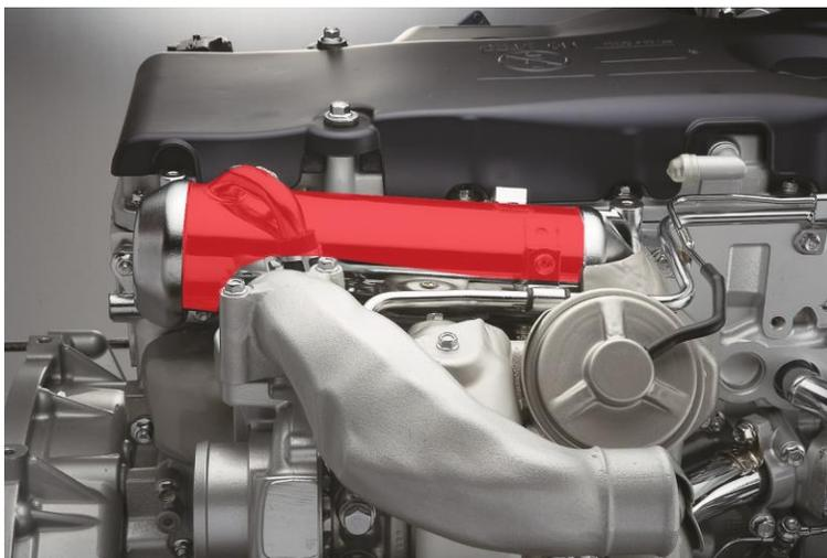
一般裝有 EGR 系統的五期柴油車，都會配有柴油碳微粒濾清器(Diesel Particulate Diffuser, DPD) 來捕捉 EGR 造成的多餘煙灰。另外柴油引擎的廢氣中含有大量的煙灰，這些煙灰在經過 EGR 系統時會通過多個控制閥門與冷卻管路，因此 EGR 保養上需特別注意廢氣循環管路是否清淨。如果沒有定期清理，這些煙灰將會留於管路內，嚴重時甚至
