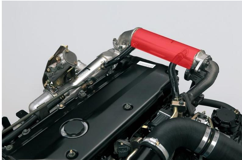
EGR 的功能是將引擎的廢氣導入進氣循環，因此配備 EGR 系統的引擎將會較沒有配備 EGR 的引擎性能較低。因此有些引擎在重負載時 EGR 系統會暫時關閉以減少引擎性能損失，在引擎低轉速或剛啟動溫度較低時 EGR 系統也會暫關閉，來增加引擎溫度並維持待速穩定。一般來說 EGR 的閥門開啟是由電腦考量引擎轉速、冷卻水溫度、進氣溫度與大氣壓力後控制。
