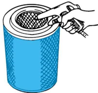
ISUZU 的貨車在設計上為了更容易使用者日常保養，在空濾保養上設計的相當簡便，車主不需要掀起車頭即可從車輛側邊檢視空氣濾芯狀況。空氣濾芯本體的檢查也相當簡單，只需使用高壓空氣由內向外吹洗即可。
