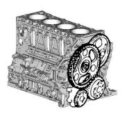
曲軸在引擎設計上扮演相當重要的角色 · 【曲軸轉速】變等於引擎轉速 · 因此所有車輛的附加配備系統都需依照曲軸的轉速作為設計指標 · 通常曲軸前方會連接水箱風扇、發電機、水泵、機油泵...
