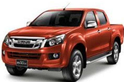
舉例來說用於 ISUZU NLR 3.49 噸的 4JJ1 貨車引擎缸徑 x 行程(95.4mm x 104.9mm)比例為 0.91:1。用於 ISUZU D-Max 休旅車的 4JK1 引擎缸徑 x 行程(95.4mm x 87.4mm)比例為 1.09:1。
